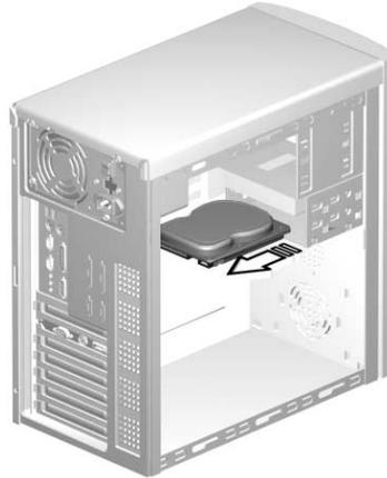
5. Installieren Sie ein neues 3,5-Zoll-Festplattenlaufwerk, und schließen Sie das Diskettenlaufwerkskabel und das Netzkabel wieder an.
