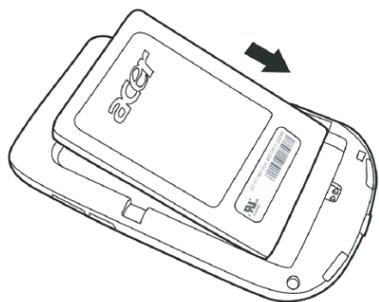
Nakloňte baterii a zasuňte ji do prostoru pro baterii na kapesním počítači podle obrázku.
