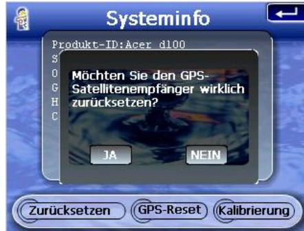
5. Der Vorgang des GPS-Reset dauert etwa eine Minute.
