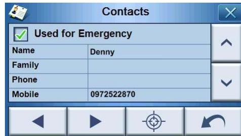
Затем оно отправит экстренное сообщение в формате "SOS: типовой текст адрес: xxxx, GPS: 0000" людям, для которых задан параметр **"Used for Emergency (Использовать в экстренных случаях)"**.
