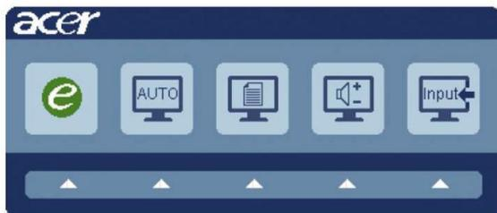
Premere il tasto funzione per aprire il menu di scelta rapida, che permette di selezionare velocemente le impostazioni più utilizzate.
