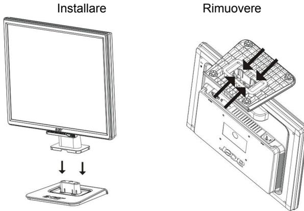
Figura 1 Installare e Rimuovere la base girevole
