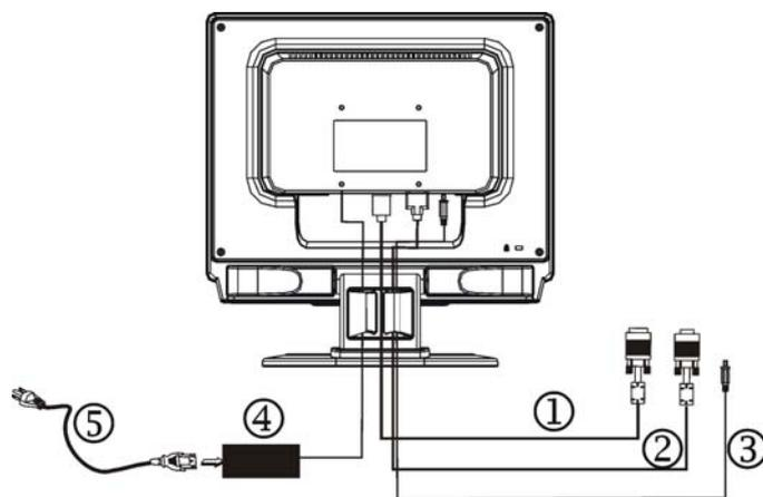
Figura 1 Conexión de los cables
