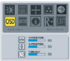
Diese Einstellung ändert die Position des OSD-Menüs auf dem Bildschirm. Mit der TIMEOUT Funktion können Sie einstellen, wann das OSD-Menü automatisch ausgeblendet wird (10 bis 60 Sekunden).
