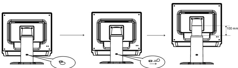
Puxe o pino da estrutura de apoio do pino como indica a figura e depois ajuste a altura. Tenha em conta que depois de puxar o pino, deve colocar a máquina de pé na mesa para evitar que a parte superior do ecrã seja ejectada.
