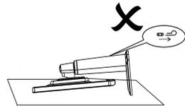
Retire la clavija del marco de soporte de la pantalla, tal y como se muestra en la ilustración y, a continuación, ajuste la altura. Tenga en cuenta al tirar de la clavija hacia fuera, que el monitor debe estar de pie sobre la mesa para evitar que la parte superior de la pantalla se expulse.
