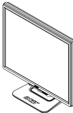
2. 沿着底座上的轨道，将屏幕及底座结合。
