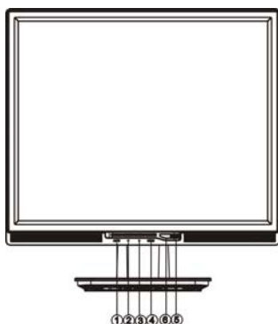
図 4 外部コントロールボタン
