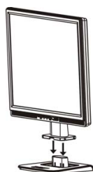
Rysunek 1 Instalacja i demontaż podstawki obrotowej Wspornik(Tylko AL1917 h/AL1917 r)
