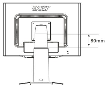
Ziehen Sie den Pin aus dem Bildschirmstützrahmen wie in der Abbildung heraus und stellen Sie dann die Höhe ein. Beachten Sie beim Herausziehen des Pins, das Gerät auf dem Tisch aufzurichten, um ein Herausspringen des Bildschirms zu verhindern.
