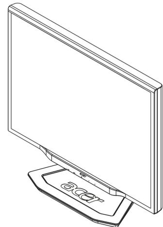
2. Befestigen Sie den Ständer in der Auslassung auf der Rückseite des Monitors.
