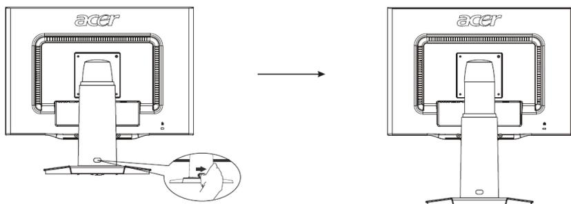
Pojistku na stojanu displeje zasuňte doprava podle obrázku a potom nastavte výšku. Všimněte si, že pro zasunutí pojistky doprava byste měli zařízení postavit na stůl, abyste předešli vysunutí horní části displeje.
