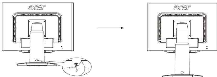
Schieben Sie den Verschluss am Bildschirmstützrahmen wie in der Abbildung gezeigt nach rechts und stellen Sie dann die Höhe ein. Beachten Sie beim Schieben des Verschlusses nach rechts, das Gerät auf dem Tisch aufzurichten, um ein Herauspringen des Bildschirms zu verhindern.
