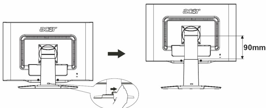
Deslice la cerradura a la derecha igual que en la figura y luego ajuste la altura. Fíjese que después de deslizar la cerradura a la derecha, la parte última de la pantalla se puede eyectar, por esa razón debe montar la máquina encima de una mesa.
