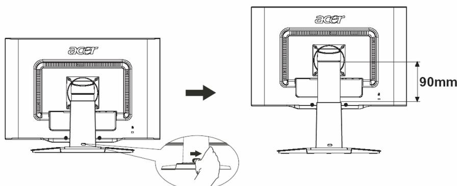
Deslizar o pino do suporte do monitor para a direita, como indicado na figura, e ajustar a altura. Para deslizar o pino para a direita, prestar atenção em manter o monitor na posição correta, para prevenir que o display seja expelido.
