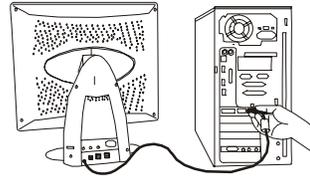
4. Conecte el otro extremo del cable de corriente a la fuente de alimentación.
