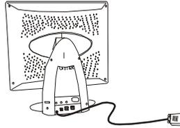
2. Conecte el cable de señal al conector de señal situado en la parte posterior del PC.
