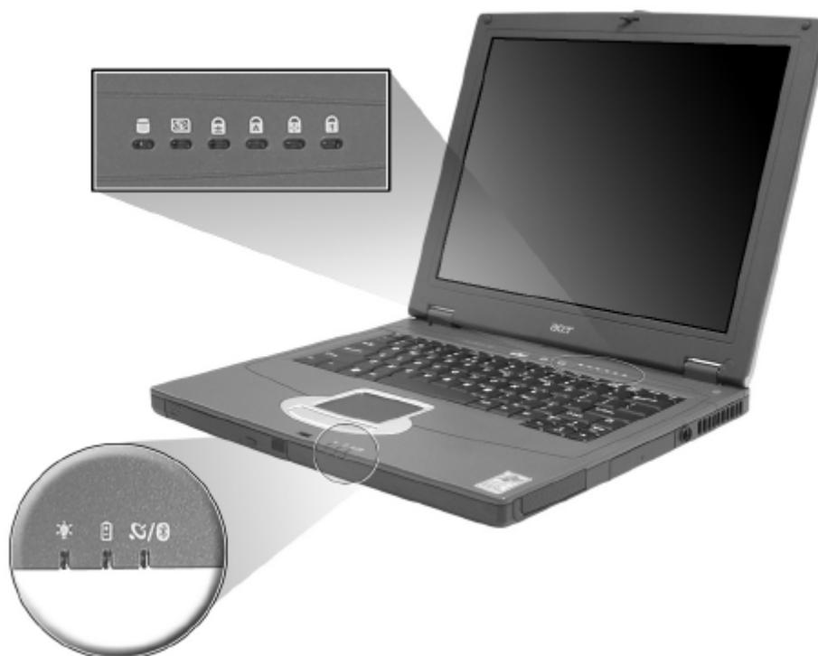
Индикаторы питания ноутбука и состояния батареи видны как при открытой, так и при закрытой крышке дисплея.
