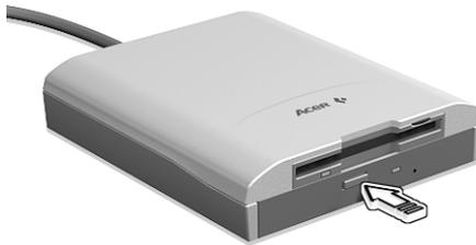
Quando il computer è spento, è possibile espellere il vassoio dell'unità utilizzando il foro di espulsione di emergenza. Per ulteriori informazioni, vedere pagina 54.
