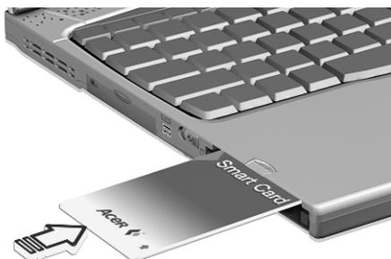
Per rimuovere la SmartCard, premere il pulsante di espulsione della SmartCard (a) e rimuovere la SmartCard (b) come mostrato nell'illustrazione seguente.
