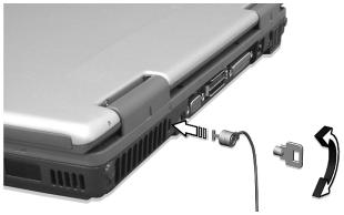
Enroulez le câble du cadenas de sécurité pour ordinateur autour d'une table, de la poignée d'un tiroir verrouillé, ou de tout autre objet fixe. Insérez le cadenas dans l'encoche et tournez la clef pour verrouiller le cadenas. Certains modèles ne possèdent pas d'encoche.
