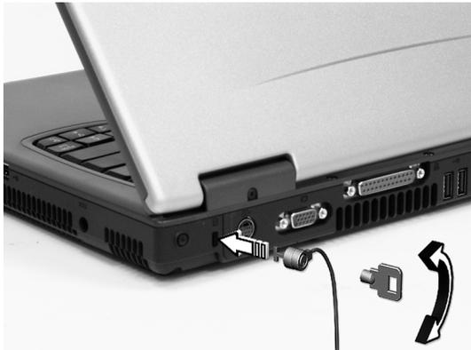
Binden Sie ein Diebstahlsicherungskabel an ein unbewegliches Objekt wie einen Tisch oder einen Griff einer abgeschlossenen Schublade. Stecken Sie das Schloß in den Anschluß für die Diebstahlsicherung, und schließen Sie dieses ab. Es gibt auch Modelle auch Schloß.
