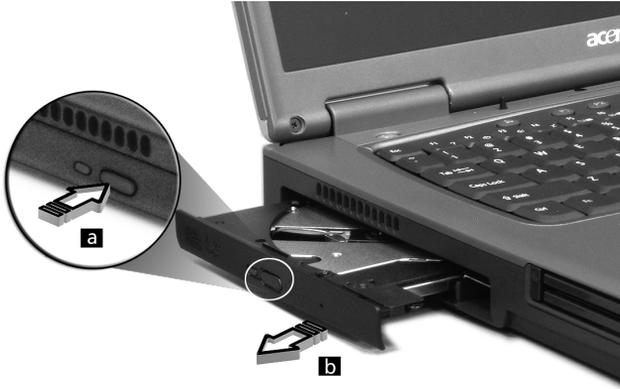
Wenn der Computer ausgeschaltet ist, können Sie den Laufwerksträger über das Notauswurfloch ausfahren. Siehe Seite 55.
