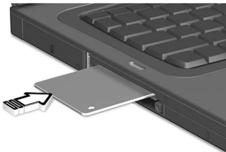
Para retirar la tarjeta Smart presione el botón de expulsión de la tarjeta Smart (a) y extráigala (b) de la manera mostrada en la figura siguiente.
