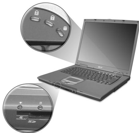
Gli indicatori dello stato della Batteria e Corrente sono visibili anche quando chiudete il display.
