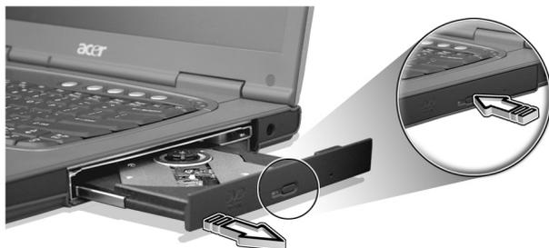
Quando il computer è spento, è possibile espellere il vassoio dell'unità utilizzando il foro di espulsione di emergenza. Vedere pagina 61.
