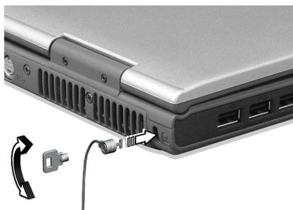
Avvolgere un cavo di blocco di sicurezza per il computer intorno ad un oggetto fisso, ad esempio un tavolo o la maniglia di un cassetto chiuso a chiave. Inserire la serratura nel foro e girare la chiave per fissare il blocco. Sono disponibili anche modelli senza chiave.
