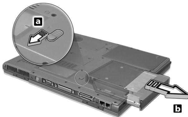
Successivamente, inserire il modulo AcerMedia opzionale nell'alloggiamento fino a farlo scattare in posizione.
