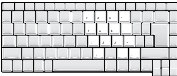
Per usare la funzione numerica dei tasti, si deve attivare il blocco numerico premendo Fn e F9 contemporaneamente.
