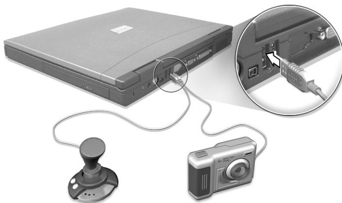
La connessione tramite porta USB è "plug and play": ciò significa che è possibile collegare e utilizzare subito un dispositivo USB, senza dover riavviare il computer. È anche possibile scollegare il dispositivo in qualsiasi momento.
