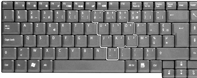
Para usar el teclado numérico integrado, active Num Lock pulsando Fn + F11 simultáneamente.
