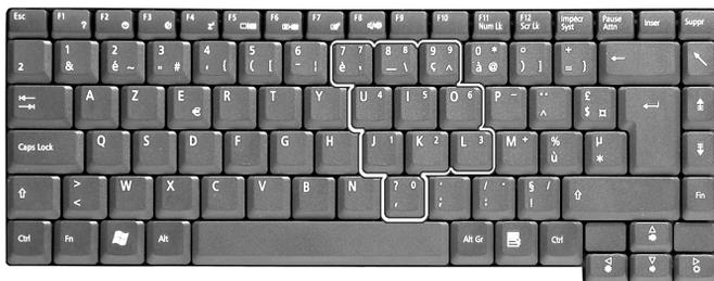
Per usare la funzione numerica dei tasti, si deve attivare il blocco numerico premendo Fn e F11 contemporaneamente.
