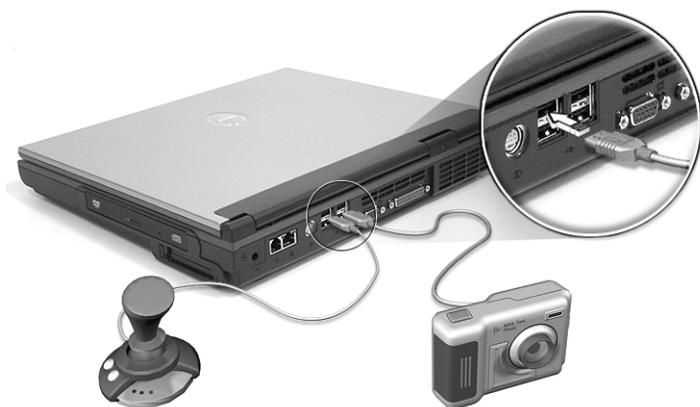
La connessione tramite porta USB è "plug and play": ciò significa che è possibile collegare e utilizzare subito un dispositivo USB, senza dover riavviare il computer. È anche possibile scollegare il dispositivo in qualsiasi momento.
