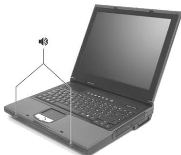
Il volume si regola tramite software, per esempio con il controllo del volume in Windows o con qualsiasi altro applicativo che abbia la regolazione del volume.
