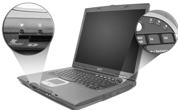
Gli indicatori dello stato della Batteria e Corrente sono visibili anche quando chiudete il display.
