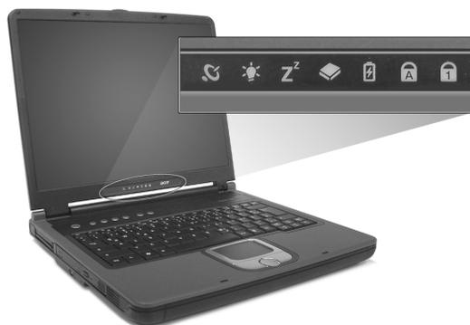
Le icone di stato Corrente e Sospensione sono visibili quando chiudete il coperchio del display, così che potete vedere lo stato del computer quando il coperchio è chiuso.
