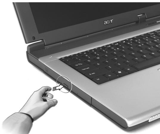
Quando il computer è spento, è possibile espellere il vassoio dell'unità utilizzando il foro di espulsione di emergenza.
