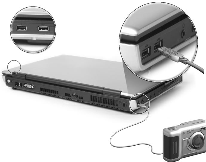
USB ermöglicht Plug-and-Play, d. h. Sie können ein USB-Gerät anschließen und benutzen, ohne den Computer neu starten zu müssen. Sie können das Gerät auch jederzeit abtrennen.
