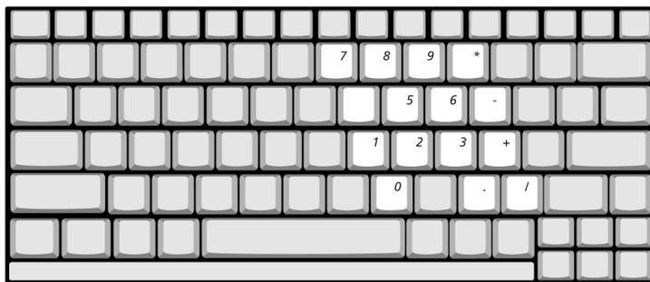
Para usar as teclas numéricas integradas, active a função NumLk premindo as teclas **Fn + F11** simultaneamente.
