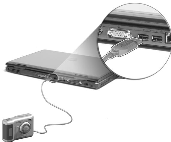
O padrão USB é Plug-and-Play, o que significa que é possível ligar e começar a utilizar um dispositivo USB sem ter que reiniciar o computador. Pode-se também desligar o dispositivo a qualquer instante.
