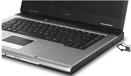
Wenn der Computer ausgeschaltet ist, können Sie den Laufwerksträger über das Notauswurfloch ausfahren.
