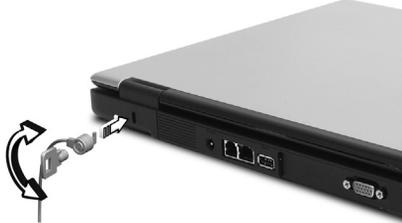
Binden Sie ein Diebstahlsicherungskabel an ein unbewegliches Objekt wie einen Tisch oder einen Griff einer abgeschlossenen Schublade. Stecken Sie das Schloß in den Anschluß für die Diebstahlsicherung, und schließen Sie dieses ab. Es gibt auch Modelle auch Schloß.
