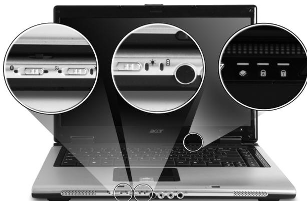
Les indicateurs du panneau avant sont visibles même lorsque l'écran LCD est fermé.
