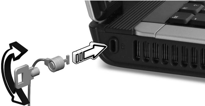
Enroulez le câble du cadenas de sécurité pour ordinateur autour d'une table, de la poignée d'un tiroir verrouillé, ou de tout autre objet fixe. Insérez le cadenas dans l'encoche et tournez la clef pour verrouiller le cadenas. Certains modèles ne possèdent pas de clef.
