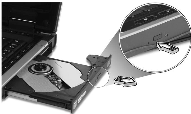
Com a alimentação desligada, é possível ejectar o tabuleiro da unidade utilizando o furo de ejeção de emergência.
