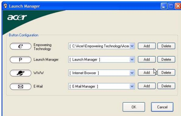
Программа Launch Manager позволяет задавать действия для 4 кнопок быстрого запуска, расположенных над клавиатурой. См. "**Кнопки быстрого запуска**" на стр. 26, где показано расположение кнопок быстрого запуска.
