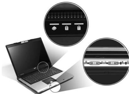
Stavové indikátory na předním panelu jsou viditelné i po zavření víka počítače.
