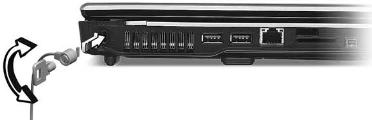
Připevněte bezpečnostní kabel k nehybnému předmětu, například ke stolu nebo rukojeti uzamčené zásuvky. Vložte zámek do drážky a otočením klíče zámek zamkněte.
