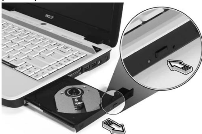
Na vypnutom počítači môžete optickú mechaniku vysunúť pomocou otvoru pohotovostného vysunutia.
