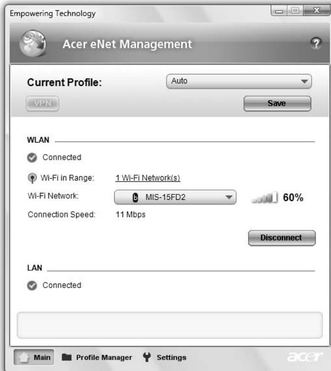
Утилита Acer eNet Management позволяет сохранять сетевые настройки для разных мест в соответствующих профилях и автоматически применяет их, когда пользователь передвигается из одного места в другое. Сохраняются такие настройки, как параметры подключения к сети (IP-адреса и параметры сервера DNS, сведения о беспроводной точке доступа и т.д.), а также стандартные настройки принтера. Из соображений безопасности утилита Acer eNet Management не сохраняет имя пользователя и его пароль.
