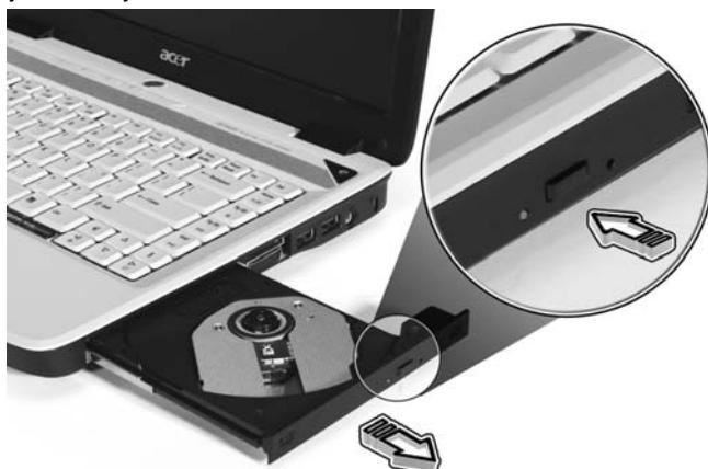
Na vypnutom počítači môžete opticú mechaniku vysunúť pomocou otvoru pohotovostného vysunutia.
