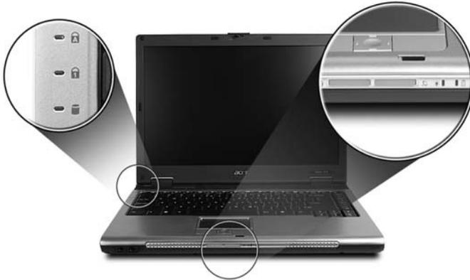
Die Statusanzeigen für Strom, Akku und Wireless-Kommunikation sind selbst dann zu sehen, wenn die LCD-Anzeige geschlossen ist.
