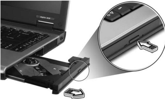
Wenn der Computer ausgeschaltet ist, können Sie den Laufwerksträger mit Hilfe des mechanischen Auswurflochs herausfahren.
