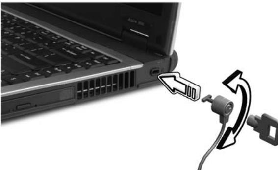
Binden Sie ein Diebstahlsicherungskabel an ein unbewegliches Objekt wie einen Tisch oder einen Griff einer abgeschlossenen Schublade. Stecken Sie das Schloss in den Anschluss für die Diebstahlsicherung, und schließen Sie dieses ab. Es gibt auch Modelle ohne Schlüssel.
