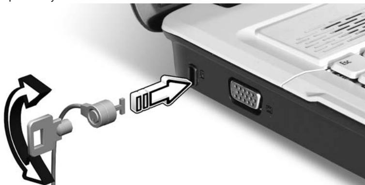
Pripojte kábel bezpečnostného zámku počítača k nepohyblivému predmetu, napríklad stolu alebo držadlu zaistenej zásuvky. Vložte zámok do otvoru a otočte klúčom kvôli zaisteniu zámku. Niektoré modely sú dostupné aj bez zámku.
