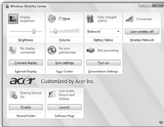
Aplikácia Windows Mobility Center zhromažďuje klúčové systémové nastavenia týkajúce sa mobility na jednom mieste, takže je potom ľahko možné nastaviť systém Acer podľa situácie pri zmene lokality, sietí alebo podľa činností. Nastavenia zahŕňajú jas obrazovky, schému napájania, hlasitosť, zapnutie a vypnutie bezdrôtovej siete, nastavenie externej obrazovky, nastavenie orientácie obrazovky a stav synchronizácie.
