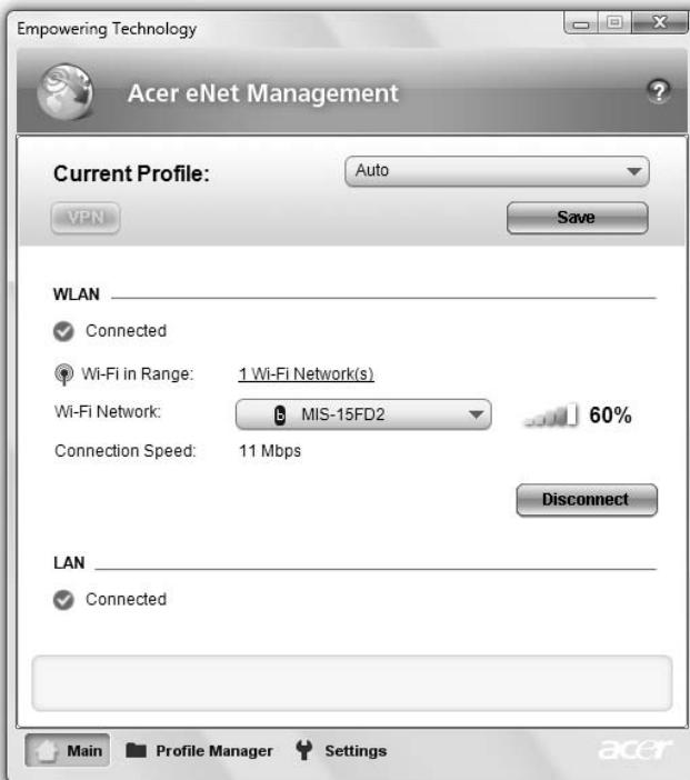
Acer eNet Management dokáže uložiť nastavenie siete podľa umiestnenia do profilu a automaticky použiť príslušný profil, keď sa presuniete z jedného miesta v sieti na iné. Uložené nastavenie obsahuje nastavenie pripojenia k sieti (nastavenie IP a DNS, podrobnosti o prístupovom bode bezdrôtovej siete, atď.) a nastavenie východnej tlačiarne. Z dôvodu zabezpečenia aplikácia Acer eNet Management neukladá informácie o užívateľskom mene a hesle.
