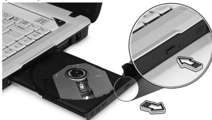
Na vypnutom počítači môžete optickú mechaniku vysunúť pomocou otvoru pohotovostného vysunutia.
