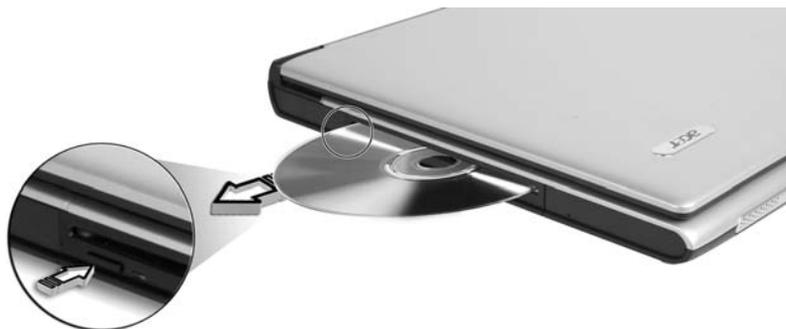
Com a alimentação desligada, é possível ejectar o tabuleiro da unidade utilizando o furo de ejeção de emergência.
