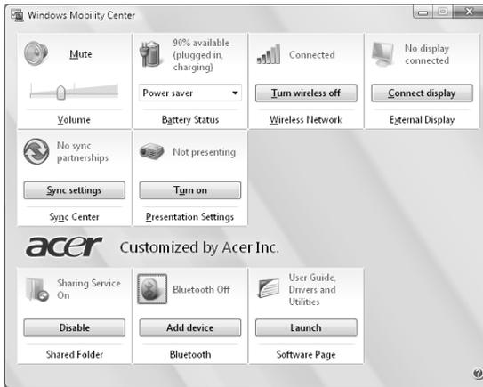
Windows Mobility Center recopila los ajustes claves de sistemas móviles, de manera que le permite configurar rápidamente su sistema Acer para adaptarse a cada situación según el cambio de ubicación, red o actividad. Los ajustes incluyen: brillo, plan de energía, volumen, conexión/desconexión de red inalámbrica, configuración de visualización externa, orientación de visualizado y estado de sincronización.
