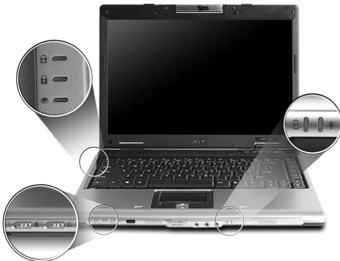
Индикаторы состояния "Питание", "Аккумулятор", Bluetooth и "Беспроводная связь" видны даже при закрытой крышке ЖК-дисплея.
