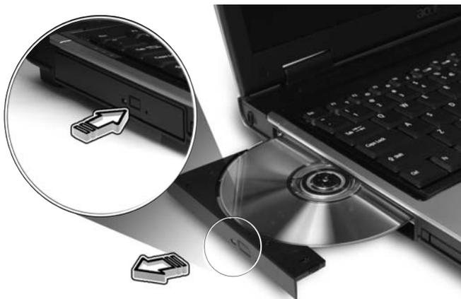
Чтобы открыть привод оптических дисков, когда компьютер выключен, вставьте скрепку в отверстие аварийного извлечения.
