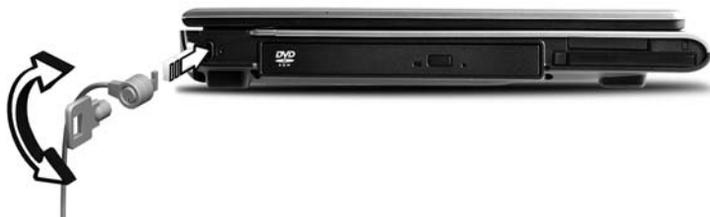
Обмотайте кабелем замка безопасности для компьютеров неподвижный предмет, например, стол или ручку запертого ящика. Вставьте замок в выемку и поверните ключ, чтобы запереть замок. Бывают и модели замков без ключей.
