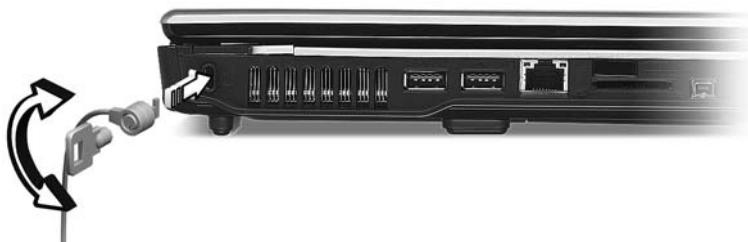
Обмотайте кабелем замка безопасности для компьютеров неподвижный предмет, например, стол или ручку запертого ящика. Вставьте замок в выемку и поверните ключ, чтобы запереть замок. Бывают и модели замков без ключей.
