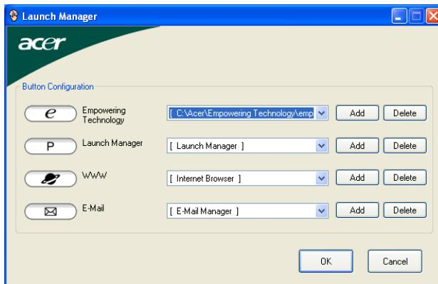
Программа Launch Manager позволяет задавать действия для 4 кнопок быстрого запуска, расположенных над клавиатурой. См. "Кнопки быстрого запуска" на стр. 29, где показано расположение кнопок быстрого запуска.
