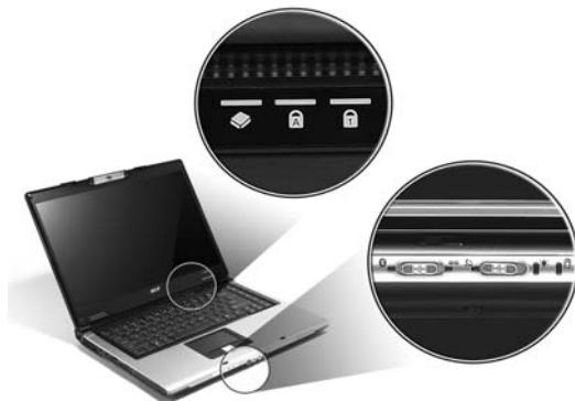
Индикаторы на передней панели видны даже при закрытой крышке компьютера.
