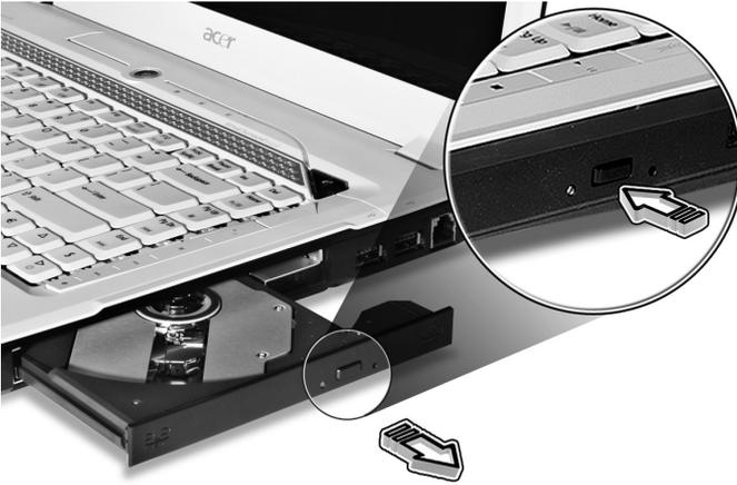
Wenn der Computer ausgeschaltet ist, können Sie den Laufwerksträger mit Hilfe des mechanischen Auswurflochs herausfahren.
