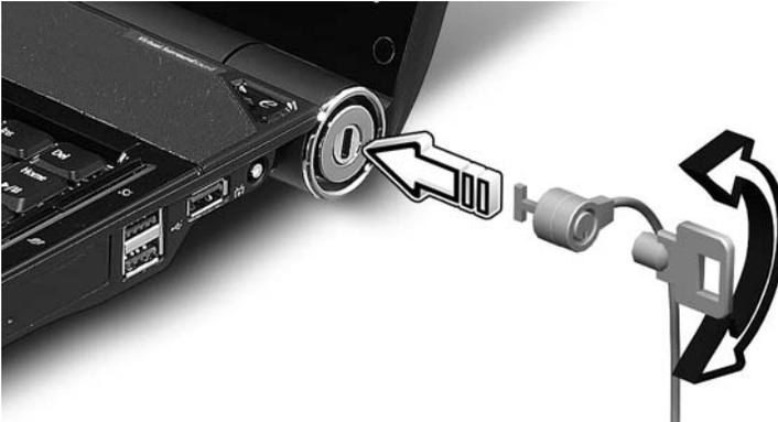
Binden Sie ein Diebstahlsicherungskabel an ein unbewegliches Objekt wie einen Tisch oder einen Griff einer abgeschlossenen Schublade. Stecken Sie das Chloß in den Anschluss für die Diebstahlsicherung, und schließen Sie dieses ab. Es gibt auch Modelle ohne Schlüssel.
