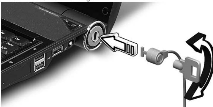
Обмотайте кабелем замка безопасности для компьютеров неподвижный предмет, например, стол или ручку запертого ящика. Вставьте замок в выемку и поверните ключ, чтобы запереть замок. Бывают и модели замков без ключей.
